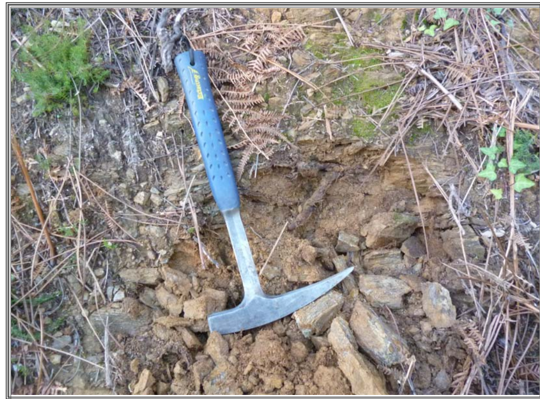
Martillo de geólogo para medida de la resistencia del macizo rocoso y su litología
