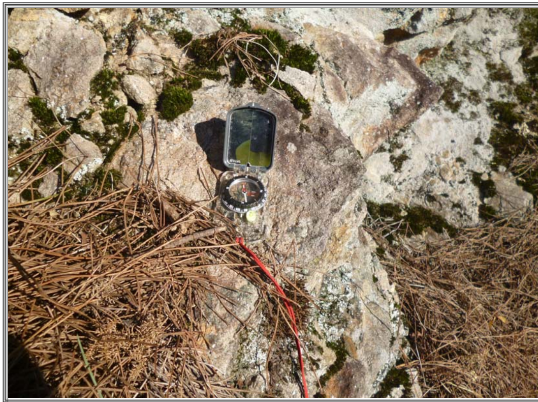
Vista de brújula con clinómetro para la medición de la dirección de buzamiento y del buzamiento de un plano de discontinuidad
