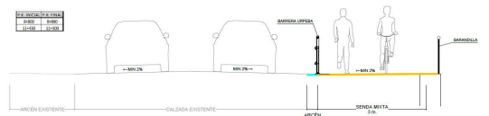
SECCIÓN TIPO: SENDA EN ESTRUTURA EN BARREIRA URPEDA (P.K 8+800 / 11+430 - 11+500)
